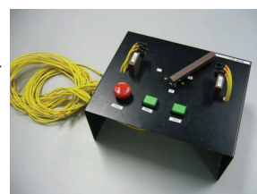
電磁リレーによるシーケンス制御
