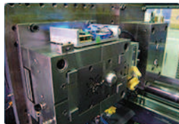
圧力や温度をセンシングするスマート金型
